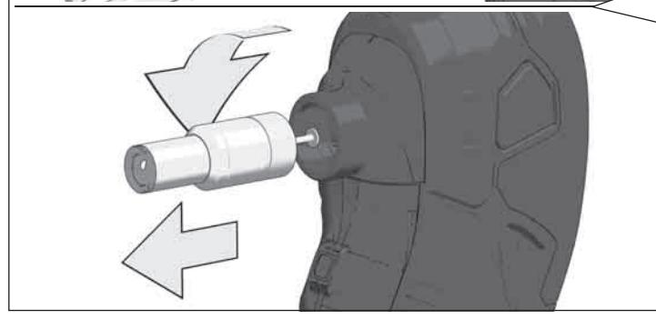
Naulat, joissa on hyvin pieni pää (< 5 mm) tai murtunut pää, voivat juuttua kiinni. Poista kiinnijuuttunut naula pihdeillä tai ruuva hylsy irti.
