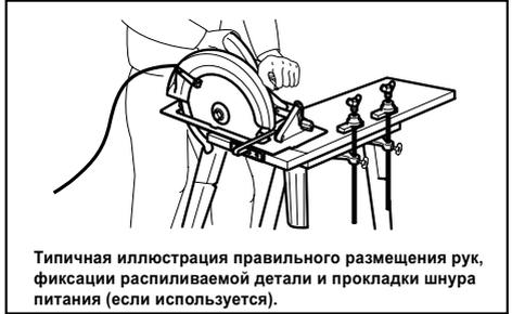
Типичная иллюстрация правильного размещения рук, фиксации распиливаемой детали и прокладки шнура питания (если используется).
