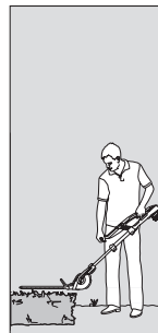
Madalalt lõikamine: Mootoriplokk – 60° kallutatud, teleskoopтору pikendatud
