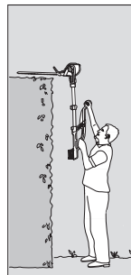
Horisontaalne lõikamine: Mootoriplokk 75° kallutatud, teleskoopтору pikendatud
